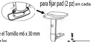
Coloque el Tornillo m6 x 30 mm para fijar los descansabrazos (3 pz) de cada lado
